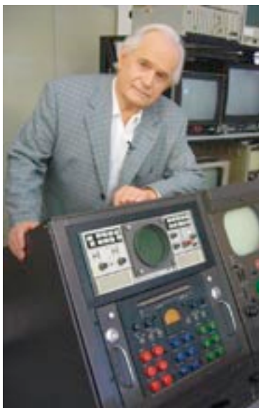
Prof. Franz Josef In der Smitten am Kontroll- und Farbmischpult für die Farbfernsehkamera TK 41c (Hersteller RCA). (Fotos: WDR)
