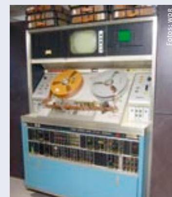
Prof. Franz Josef In der Smitten im Interview mit Karl-Friedrich Baumgärtel, dem Autor der Rückblende, vor der elektronischen Farbfilm-Übertragungsanlage aus dem Jahr 1963 (Bezeichnung FC 35 L 15 A, Hersteller Fernseh GmbH); wdr-Azubi Elke Braun an der HDTV-Kamera. Rechts: Die Farbfernseh-Magnetaufzeichnungsanlage für 2-Zoll-Bänder (Hersteller RCA).
